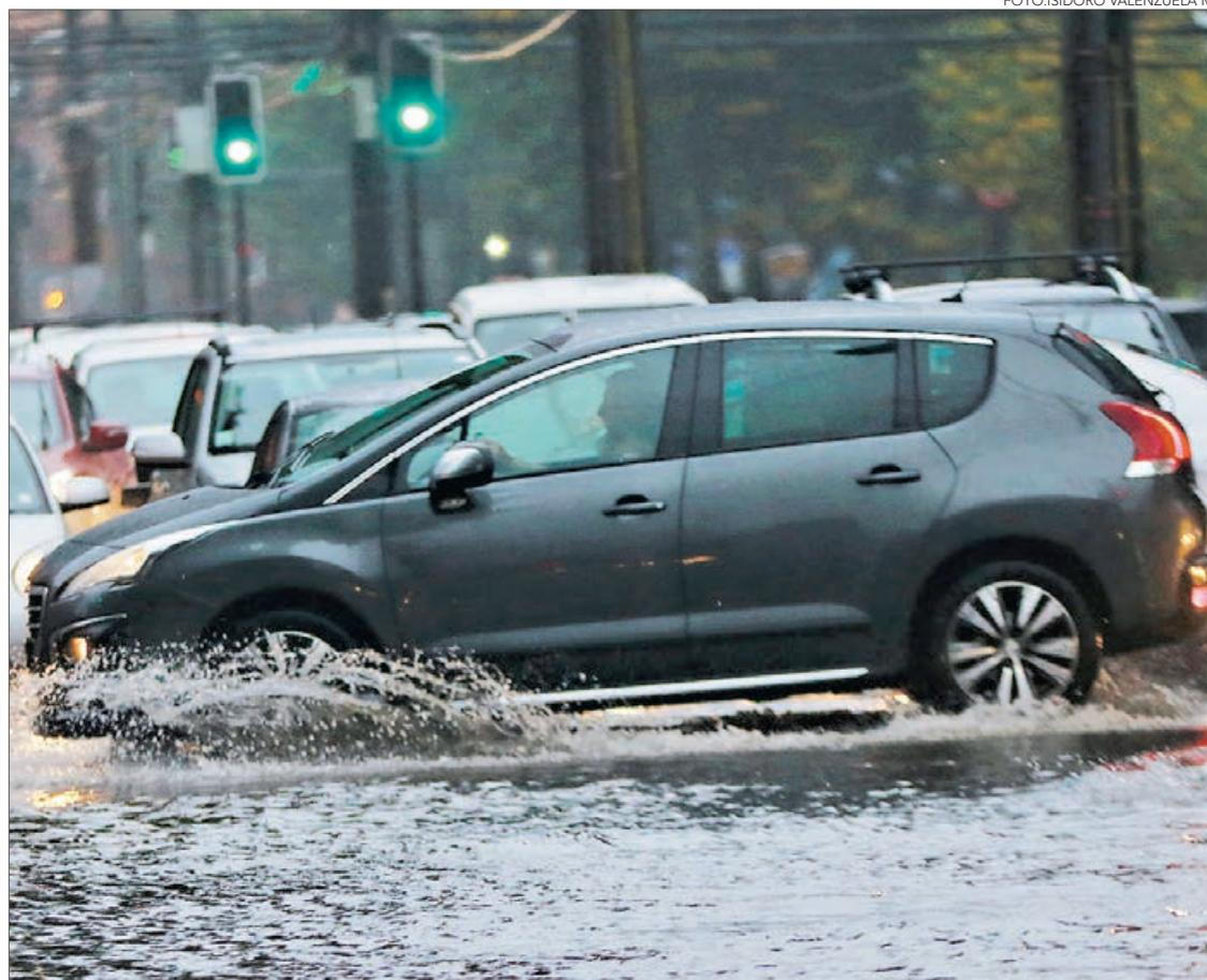
te una menor adherencia. "El agua actúa como una película entre el caucho y el pavimento permitiendo una mayor superficie de deslizamiento desde el momento de frenado. Al disminuir las fuerzas contrarias al deslizamiento del neumático, también, se pierde control sobre la dirección que toma el vehículo por efecto de la
